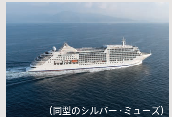
シルバー・ムーン 新造船 Silver Moon ・総トン数：40,700トン ・全長：212.8m ・全幅：27m ・乗客定員：596名 ・乗組員数：411名 ・就航：2020年8月予定
