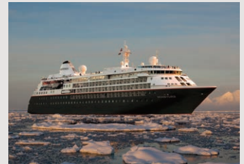
シルバー・クラウド Silver Cloud ・総トン数：16,800トン ・全長：156.7m ・全幅：21.5m ・乗客定員：200名(極地) / 254名(その他) ・乗組員数：217名(極地) / 223名(その他) ・就航：2017年11月
